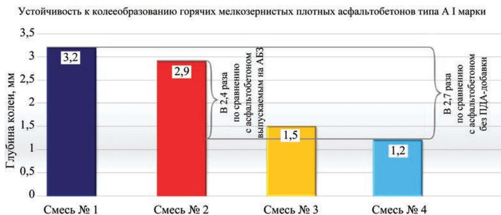
Рис. 4. График колееобразования контрольных образцов
